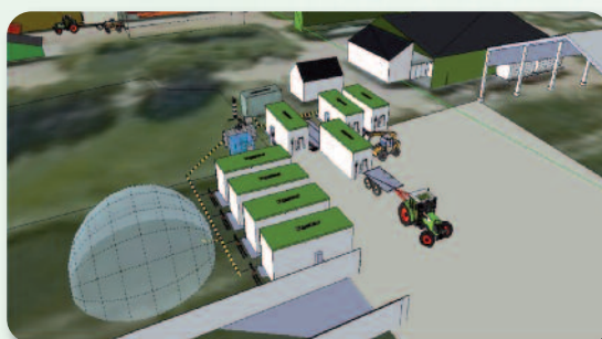
Digesteurs « ½ conteneurs maritimes » avec poche de stockage de biogaz (cas 2)
