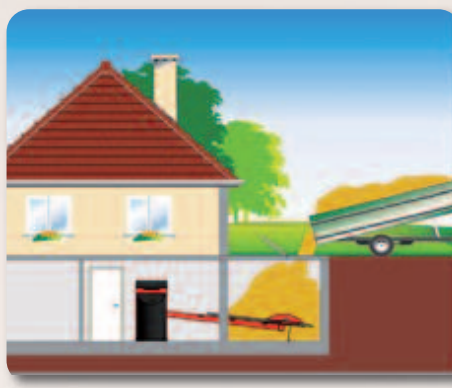
Silo et chaudière enterrés
