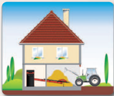
Chaudière au RDC, silo ouvert sur l'extérieur
